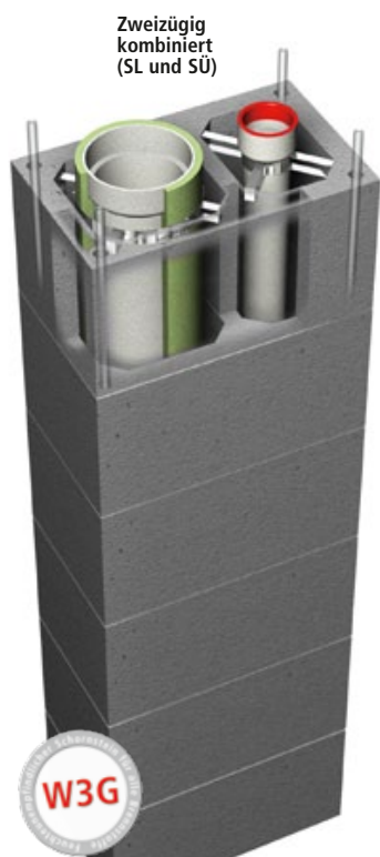
Zweizügig kombiniert (SL und SÜ) mit Installations- schacht f. Solar u. Photovoltaik- leitungen
