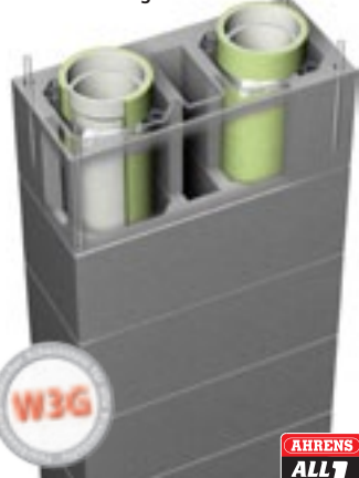
Zweizügig (beide Züge SL) mit Installationsschacht f. Solar u. Photovoltaikleitungen
