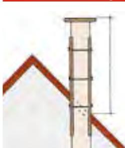
Eine andere Zusatzmaßnahme stellt das Aussteifungsset VS dar, welches auch nachträglich montiert werden kann. Es liegt außen korsettartig um den Schornstein und wird mit der Dachkonstruktion verschraubt. Eine separate Einbauanleitung liegt dem Aussteifungsset VS bei.
