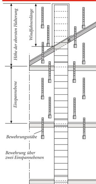
Der Nachweis der Standsicherheit für Abgasanlagen (zulässige Höhen über Dach bzw. freistehende Längen) kann bei Ausführung mit dem Statikset BS im Rahmen unserer Typenstatik erbracht werden.
