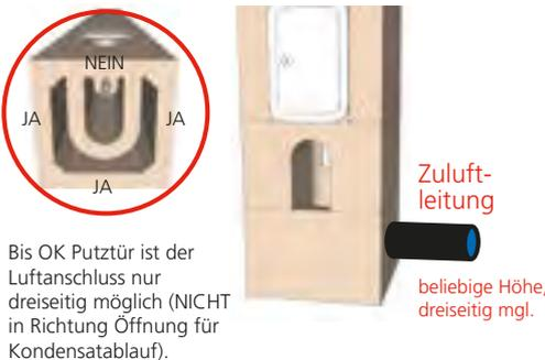
Bis OK Putztür ist der Luftanschluss nur dreiseitig möglich (NICHT in Richtung Öffnung für Kondensatablauf).
