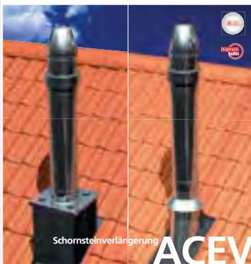
Optional kann eine ACEV-Schornsteinverlängerung für LAF-Schornsteine eingesetzt werden (bei zweizügigen Anlagen nur mit mittig liegendem Installationsschacht). Anstelle der VK-Abdeckplatte (09) wird eine Edelstahl-Übergangsplatte geliefert, auf die der Edelstahlmantel mit Edelkeramikinnenrohr montiert wird. In diesem Fall ist zwingend das Vorhandensein des Statiksetz BS erforderlich (s. Seite 12). Der Wechsel kann über oder im Dach erfolgen.
