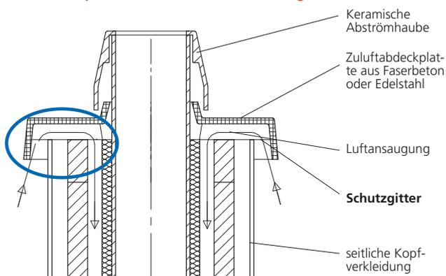
Bei AHRENS LAF-Premiumschornsteinsystemen und AHRENS Überdruckabgasleitungen kommt in der Regel die VK-Abdeckplatte (09) mit **untenseitiger Luftzuführung** zum Einsatz.
