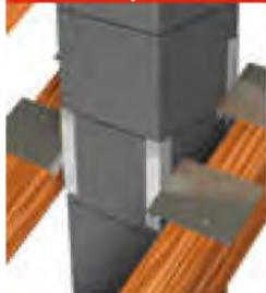
Nicht zusätzlich armierte Schornsteine sind generell im Dachdurchtritt seitlich abzustützen, um die Windkräfte sicher ableiten zu können. Dies kann einfach, schnell und sicher mit dem optionalen AHRENS Sparrenhalter SP4 erfolgen.
