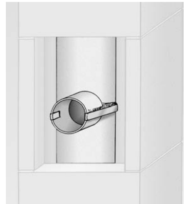
6. Mit Montageband den angeklebten Stutzen fixieren. Die unter Punkt 1 entnommene Dämmschale auf Passform schneiden und wieder dicht einsetzen.
