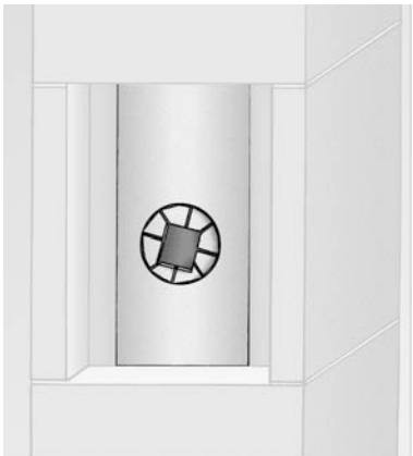
4. Loch einflexen. Mit Flex Anzahl der Kreuzschnitte erhöhen.
