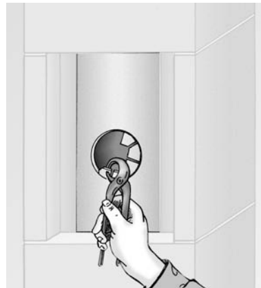
5. Mit Zange Rundung in kleinen Schritten ausknipsen.
